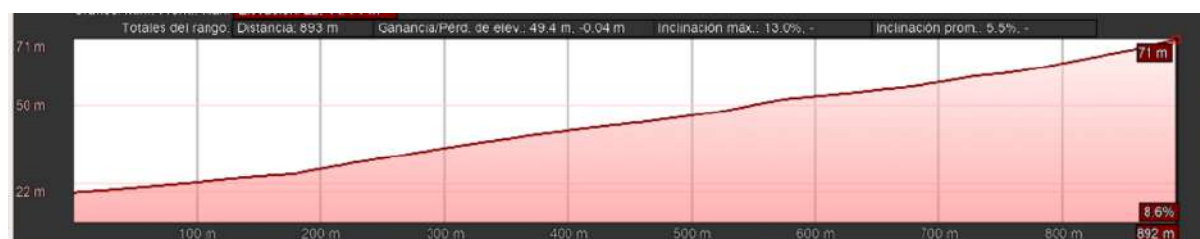
Figura 26. Pendiente del tramo C, subtramo II. Fuente: topografía de Google Earth.
