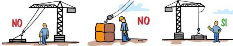
**ESTÁ PROHIBIDO** utilizar los elementos de elevación para arrancar cargas adheridas al suelo o paredes, así como cualquier otra operación extraña a las propias de manutención de cargas.
