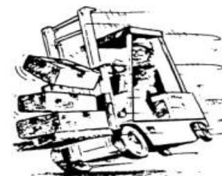
Cuando maneje un **vehículo cargado en subida** lleve el peso en la parte delantera. **Maneje hacia adelante en subida y en reversa hacia abajo.**
