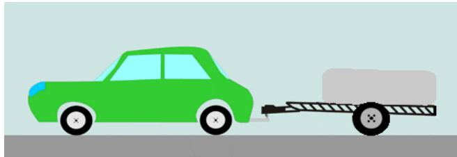
El remolque se trasladará sin sacudidas ni arqueamientos peligrosos. Al frenar, el peso de la lanza más la inercia de ésta, empujará levemente hacia abajo la carrocería del vehículo mejorando notablemente la adherencia de las cubiertas sobre el asfalto.
